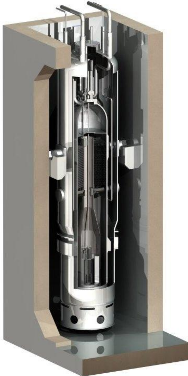
Reactor modular. Foto: Oregon SU
