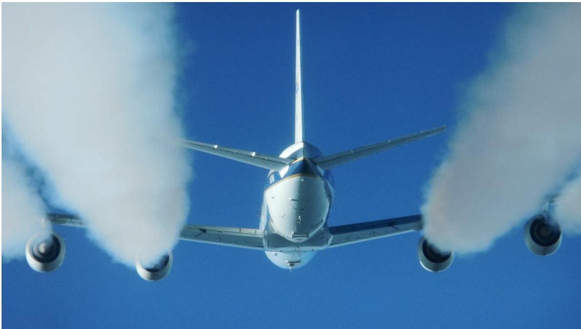
Vapor de las estelas de condensación de los motores del DC-8 vistas desde el Falcon volando a sólo unos 90 metros por detrás. (Foto: NASA / Eddie Winstead)
