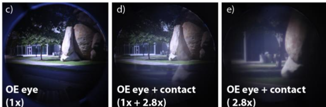
Imágenes captadas en exteriores a través de la lente de contacto y el modelo mecánico de ojo. C: Imagen captada con solo el modelo mecánico de ojo. D: Imagen captada con el modelo de ojo y la lente de contacto. Esta imagen muestra por qué cada uno de los dos estados -el normal y el 2,8x- no deberían ser usados al mismo tiempo. Aquí, ninguna sección de la lente es bloqueada por las gafas y el resultado es una imagen con un contraste mermado y sin mejoras apreciables. E: Imagen captada con solo la porción periférica amplificadora de la lente de contacto, 2,8x, y el modelo de ojo. (Imágenes: Optics Express)
